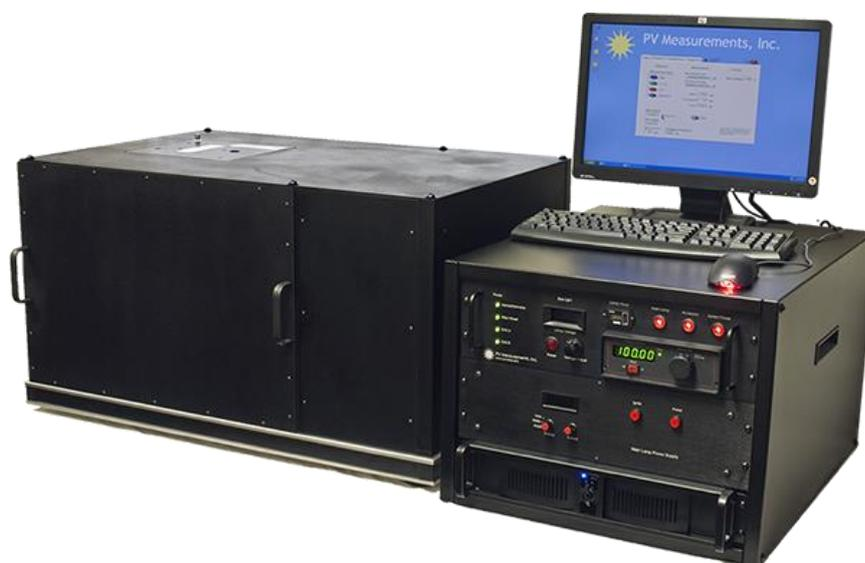
Рисунок 14 – Система по измерение квантовой эффективности PV Measurements QEX10
