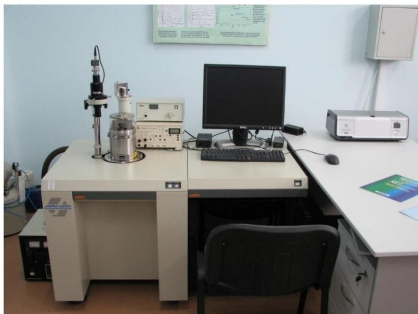
Рисунок 17 – Сканирующий зондовый микроскоп JEOL JSPM-5200
