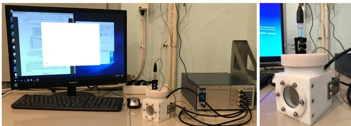
Рисунок 15 – Потенциостат-гальваностат P-40X с модулем измерения электрохимического импеданса FRA-24M
