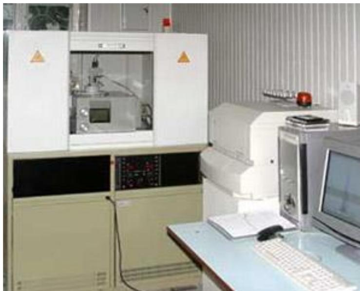
Рисунок 18 – Рентгеновский дифрактометр Дрон-6
