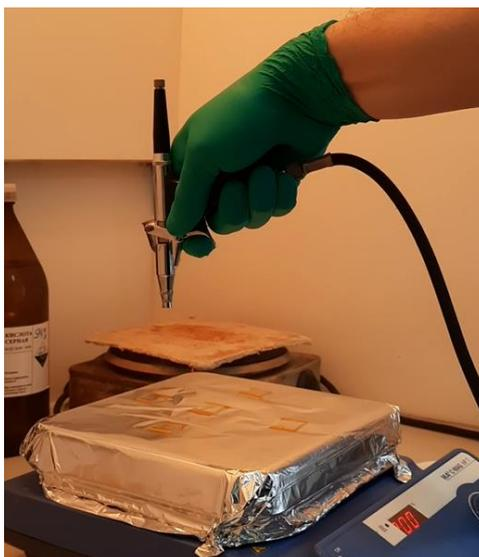
Рисунок 12 – Нанесение раствора методом спрей-пиролиза
