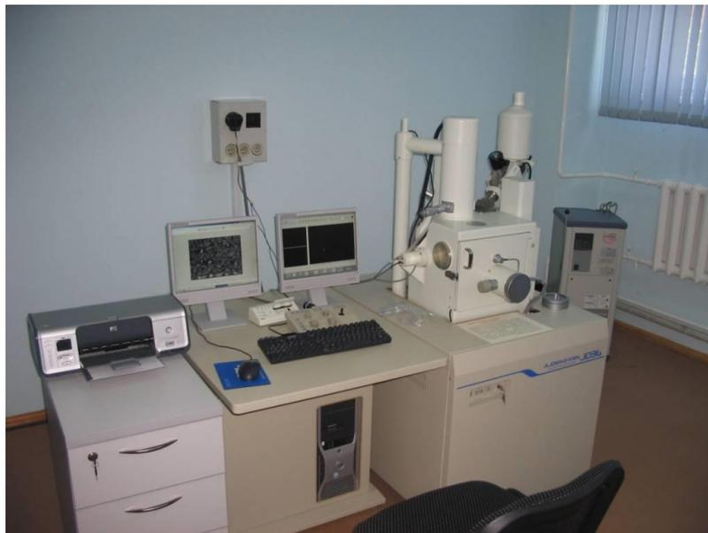
Рисунок 16 – Растровый электронный микроскоп JEOL JSM-6490LA
